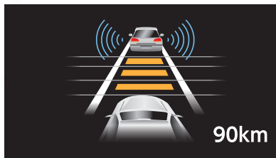
CACC : Cooperative Adaptive Cruise Control 通信利用型定速走行・車間距離制御装置
